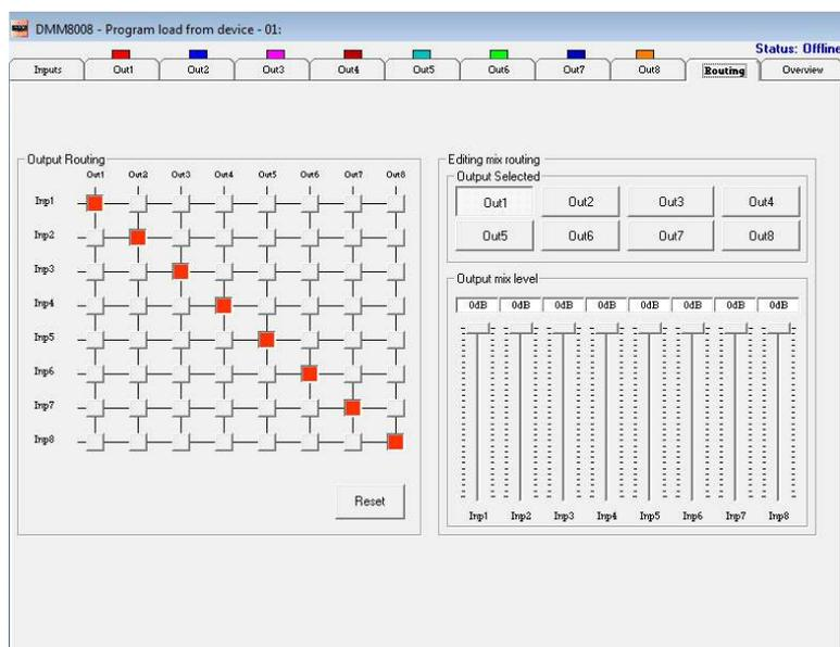
La pagina di routing permette di impostare la struttura del DMM 8008 e di assegnare a ciascuna uscita gli ingressi desiderati.
