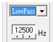
Una volta attivato, il filtro Low Pass è destinato ad essere utilizzato principalmente sull' ingresso del microfono selezionato, al fine di ridurre la quantità di alte frequenze senza influenzare in modo significativo la qualità della voce e aumentando l'immunità del feedback.
