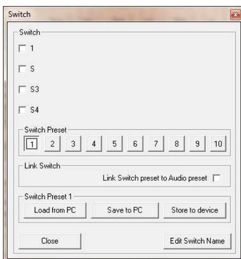
Da questa finestra, di fatto, possono essere impostate 4 linee di uscita "switch" disponibili sul pannello posteriore del DMM 8008 e utili per il controllo di dispositivi remoti 0V o 5V.
