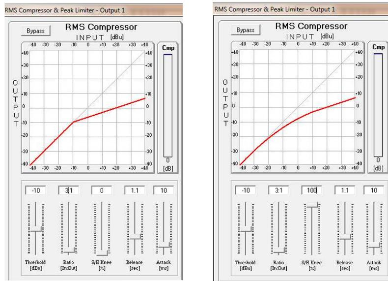
**"Threshold"**: la soglia selezionabile del Compressore va da + 14,2dBu (OFF) / -33,8dBu a passi di 0.2dBu
