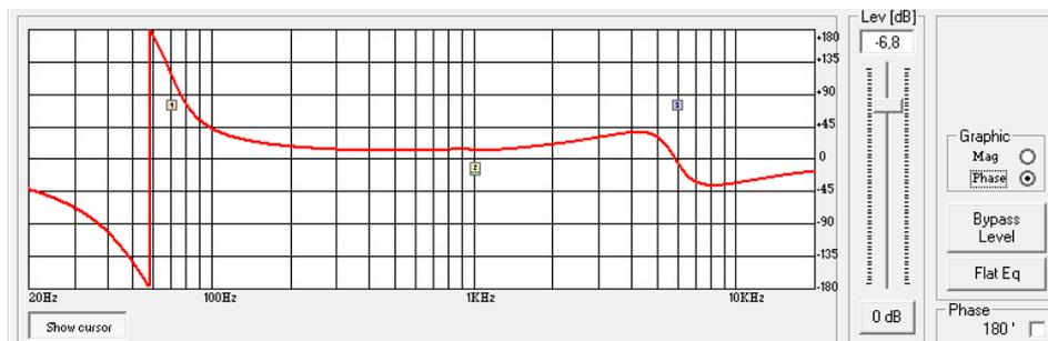
**Step dB** - questa semplice funzione permette di impostare la risoluzione in dB delle linee della griglia del grafico. La risoluzione può essere impostata in una gamma da 5dB fino a 50dB, a passi di 5 dB.
