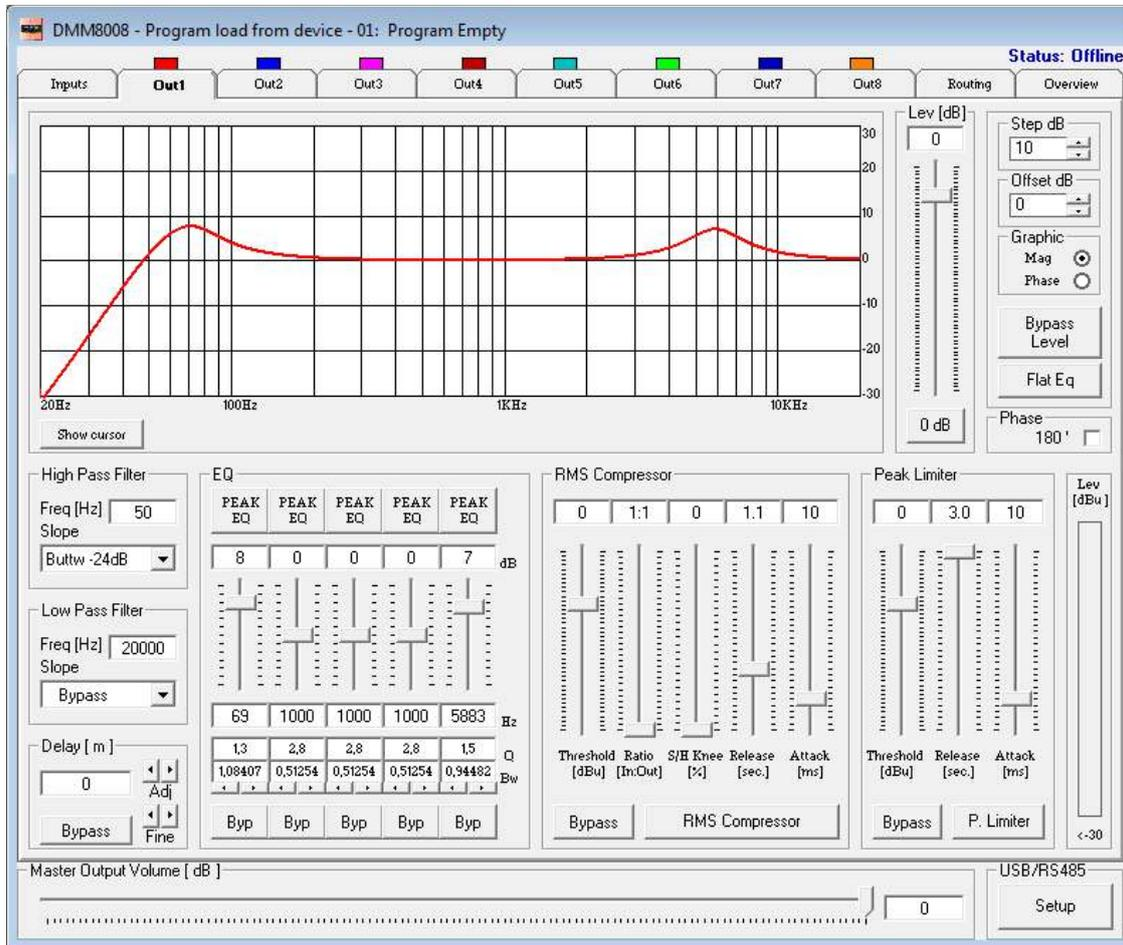
Filtro passa alto: da questo sub-frame, è possibile impostare il filtro passa-alto (HPF) per i canali di uscita .
