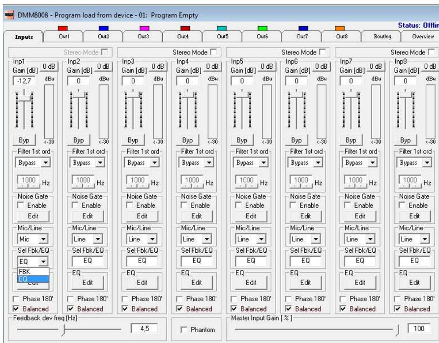
Quando è selezionato l'ingresso microfonico, l'utente può scegliere di processare il segnale con l'equalizzatore a 3 bande, o con un Feedback Eliminator.
