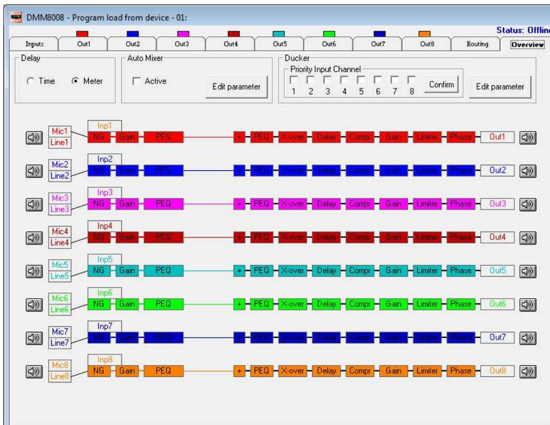
All'interno di questa pagina, possono essere controllati tutti i canali di ingresso (microfono e linea), così come è possibile accedere su ogni processo tramite lo schema a blocchi. In particolare, quando si seleziona l'ingresso microfonico possono essere richiamate le configurazioni di equalizzazione e eliminazione feedback. È anche possibile selezionata l'unità per definire la quantità di ritardo disponibile su ogni uscita. Il ritardo può essere impostato in "metri" o "millisecondi".
