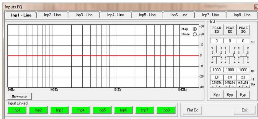
**EQ: da questo "sub-frame" è possibile impostare per i canali di ingresso tre filtri peaker (Bell) o Filtri Q Shelving variabili.**
