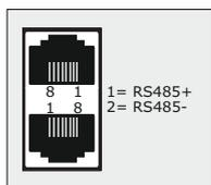
L'uscita RS485 OUT (12) può essere collegata alla presa RS485 IN di un ulteriore DMM 8008. Pertanto, possono essere collegate in catena fino a 64 unità. Se più unità sono collegate e se si utilizzano linee di controllo più lunghe, l'uscita di controllo dell'ultima unità della catena deve essere dotata di una resistenza di terminazione (120 Ohm tra il pin 1 e 2 del collegamento), per evitare interferenze.
